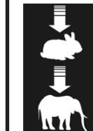
Regolazione della velocità nella leva di comando: nella prima posizione, circa a metà corsa, lo spaccalegna è più veloce ma meno potente, premendo a fondo la leva, la macchina rallenta ma spacca il legno a piena potenza.
