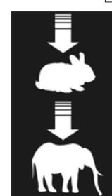
Regolazione della velocità nella leva di comando: nella prima posizione, circa a metà corsa, lo spaccalegna è più veloce ma meno potente, premendo a fondo la leva, la macchina rallenta ma spaccia il legno a piena potenza.
