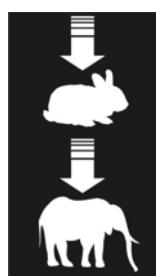
Geschwindigkeitsverstellung mit Bedienhebel: in der ersten Stellung, ungefähr auf halbem Schaltweg, funktioniert der Holzspalter schneller, aber mit geringerer Leistung, wird der Hebel bis zum Anschlag geschoben, ist die Maschinengeschwindigkeit niedriger, die Holzspaltung erfolgt aber mit voller Kraft.
