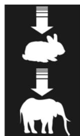
Réglage de la vitesse dans le levier de commande : dans la première position, à mi-course environ, la fendeuse de bois est plus rapide mais moins puissante. En pressant le levier à fond, la machine ralentit mais débite le bois à pleine puissance.
