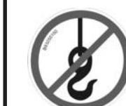
Interdiction d'accrochage : ne pas utiliser le point indiqué sur le pictogramme pour soulever la machine.
