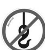
Hubverbot: Der auf der Abbildung dargestellte Punkt darf nicht für das Heben der Maschine verwendet werden.
