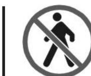
Il est interdit de stationner dans le rayon d'action de la machine. A part l'opérateur aucune personne ou animal ne peut stationner dans un périmètre de 5 m de la machine.
