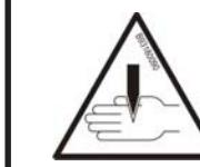
Danger de coupure ou d'écrasement de la main: ne jamais toucher les zones à risque lorsque la lame est en mouvement.
